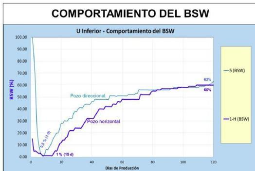
Figura # 9. Comparación del comportamiento del BSW entre un pozo horizontal y un pozo direccional.
