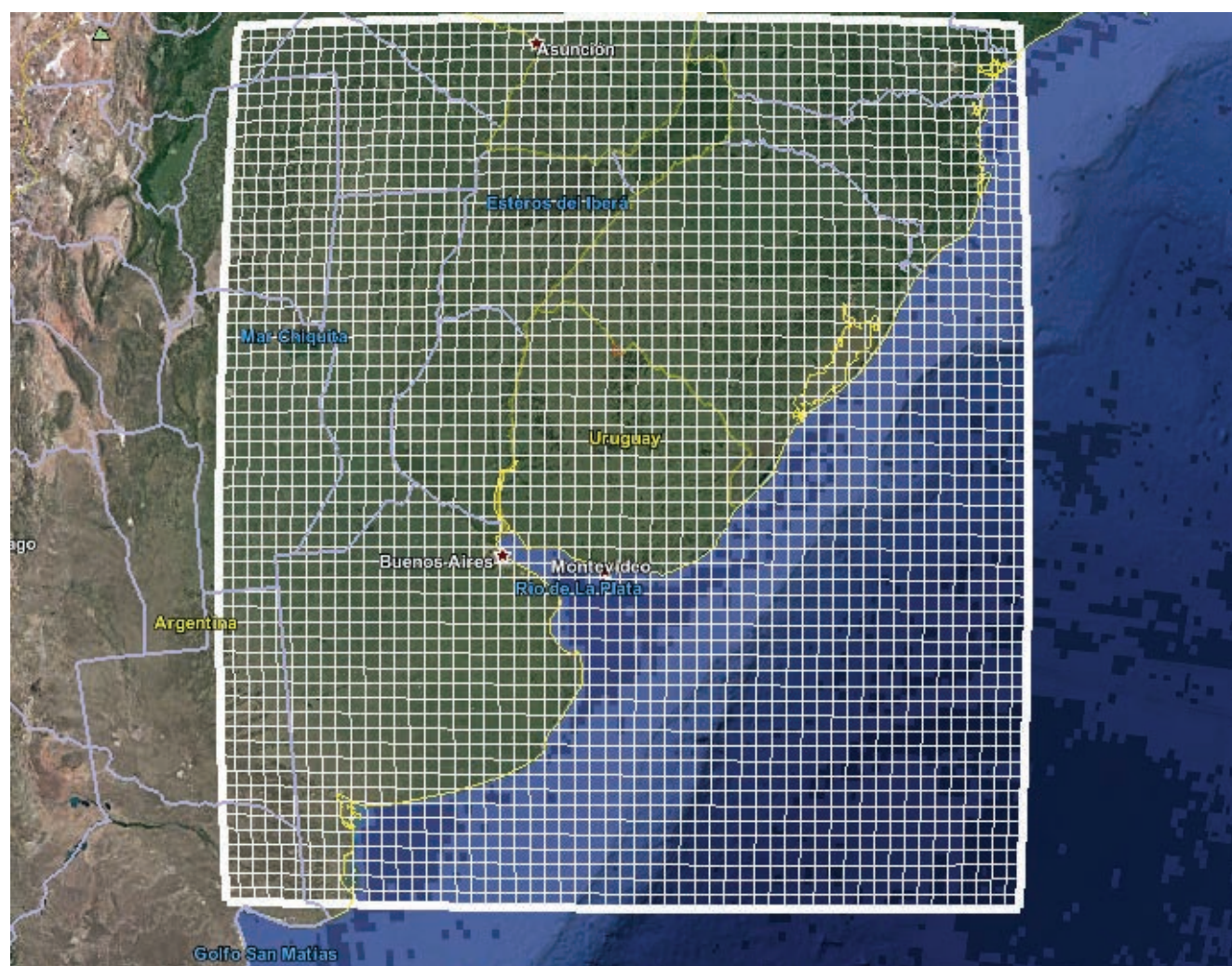
Figura 2. Dominio WRF de 30 km utilizado para los pronósticos operativos de energía eólica
