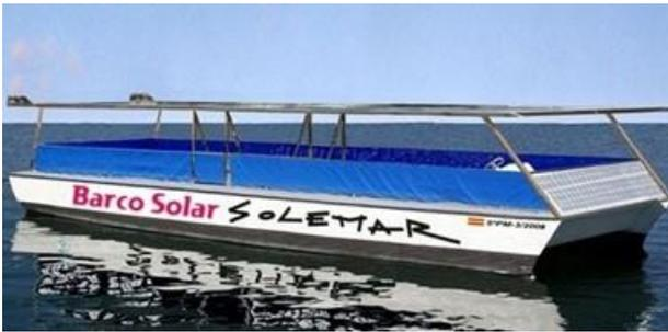
El Solemar es un catamarán solar de 80 pasajeros creado por el astillero Seacleaner Trawler, con sede en Mallorca. Sus 16 placas solares ubicadas en el techo le proporcionan toda la energía y alimentan a 24 baterías para garantizarle unas 150 horas sin necesidad de luz. Sus
