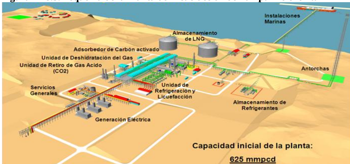
Figura N° 8.3. Esquema de la Planta de Licuefacción de Pampa Melchorita
