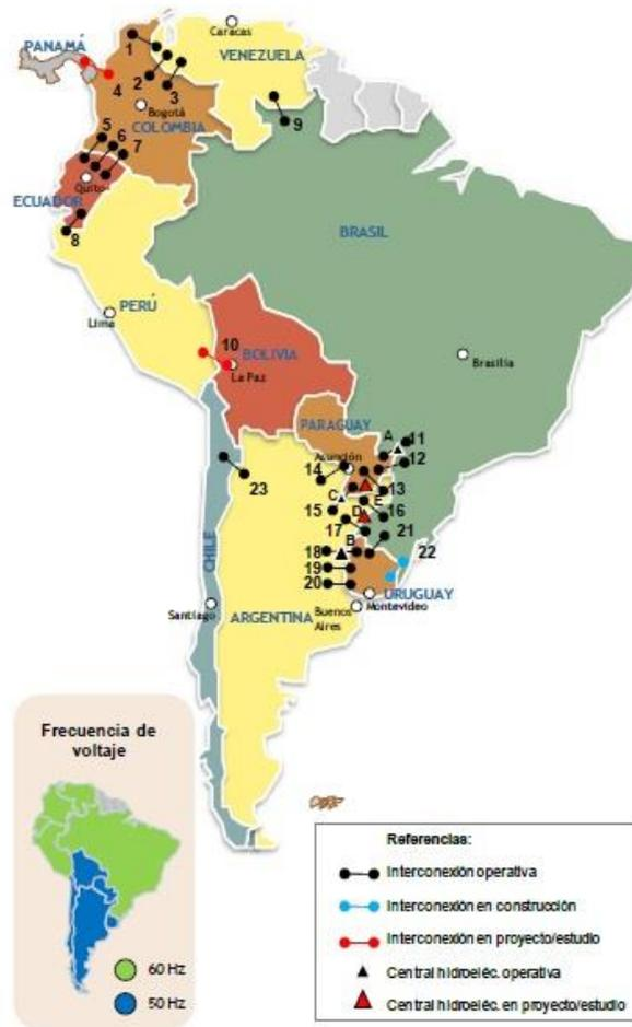
Ilustración 1. Principales Interconexiones Eléctricas en América del Sur
