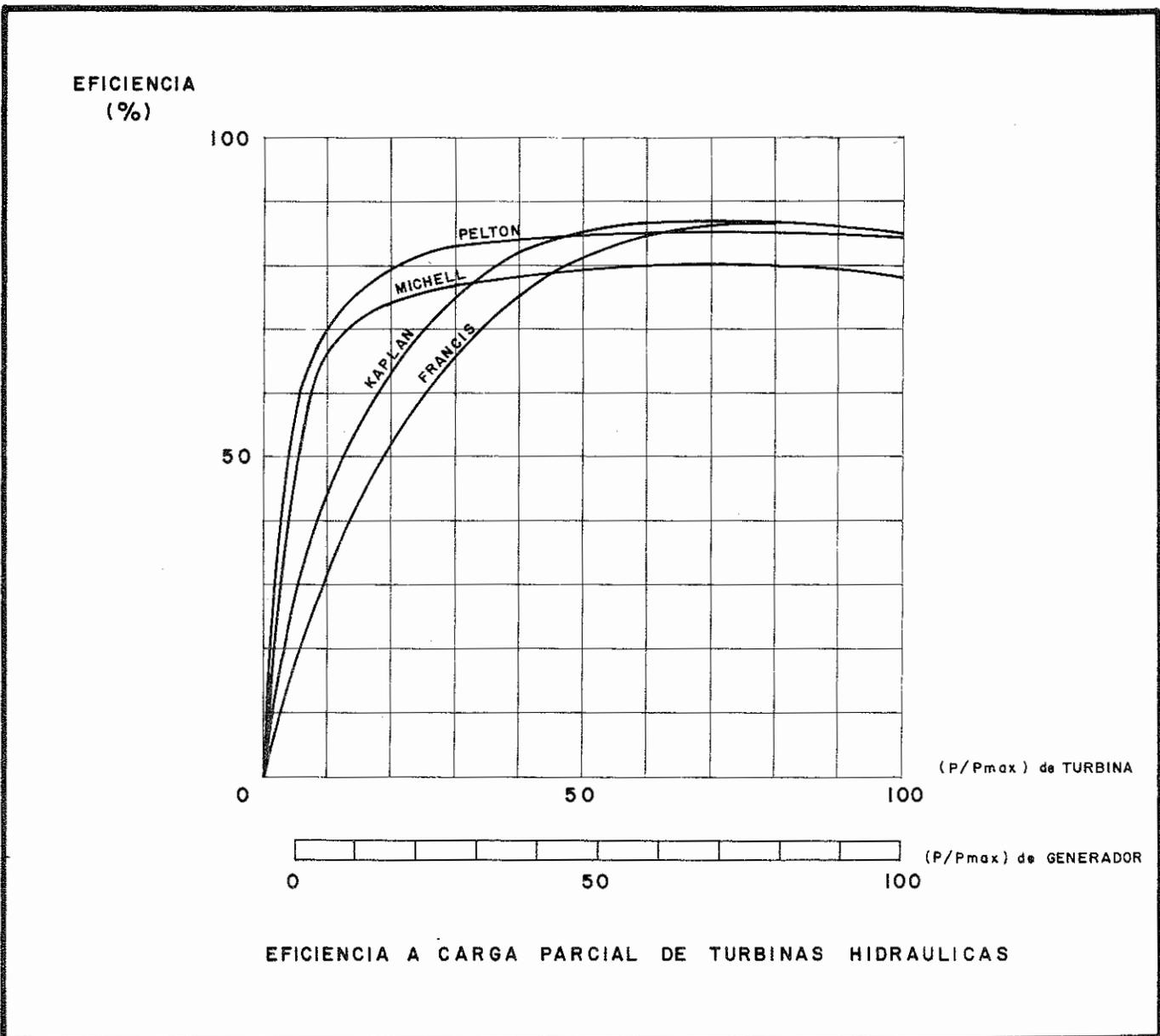
EFICIENCIA A CARGA PARCIAL DE TURBINAS HIDRAULICAS
