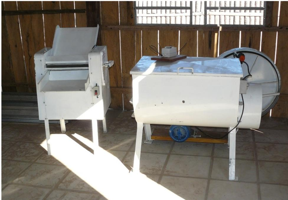
**Ilustración 11: Amasadora (der.) y refinadora (izq.) en la panadería de La Leona**
