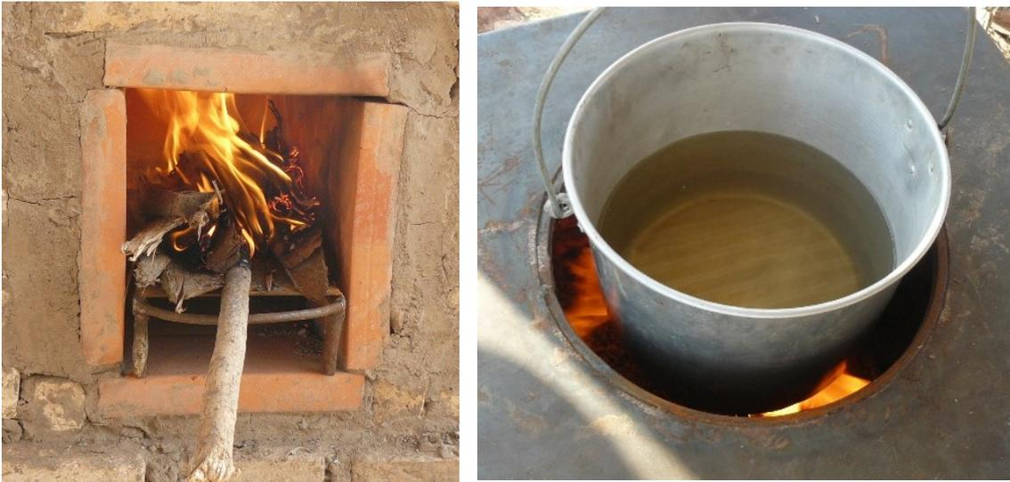
**Ilustraciones 21 y 22: hogar con fuego y olla sumergida en hornalla principal**
