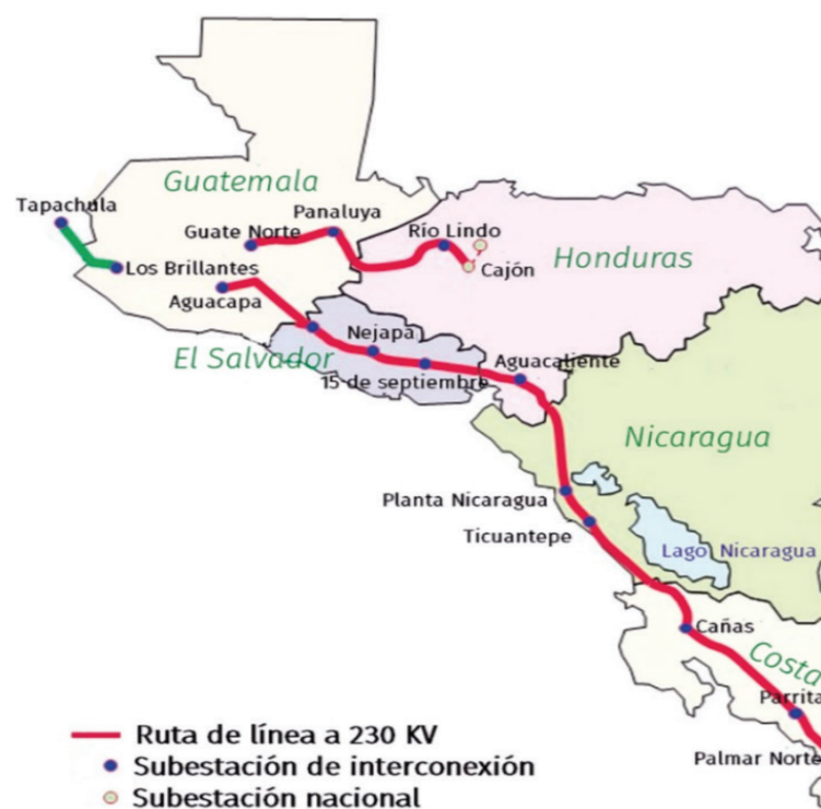
Figura #2 Centroamérica: Sistema Eléctrico Interconectado
