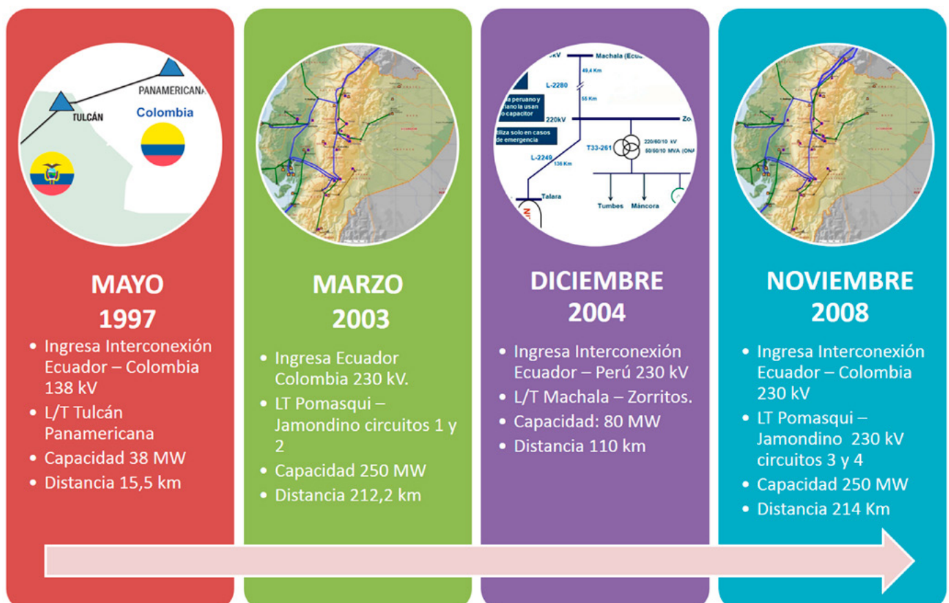
Figura 1. Secuencia entrada Líneas Interconexión.
