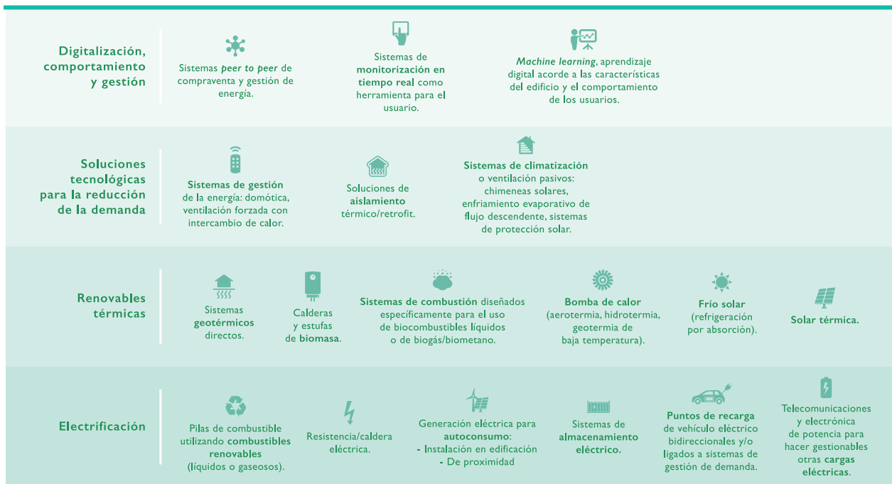
FIGURA 6.4 Tecnologías disponibles para la descarbonización en edificación
