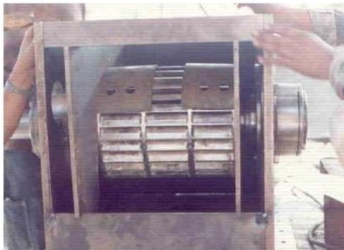
Figura 12.- rotor de una turbina Michell
