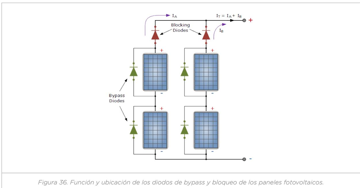
Figura 36. Función y ubicación de los diodos de bypass y bloqueo de los paneles fotovoltaicos.
