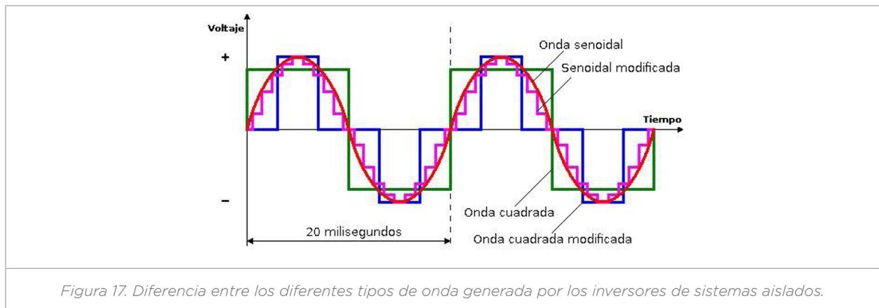
De esta manera, la selección del inversor adecuado para sistemas aislados requiere conocer la potencia nominal del inversor, la potencia pico y el tipo de onda de salida del mismo.
