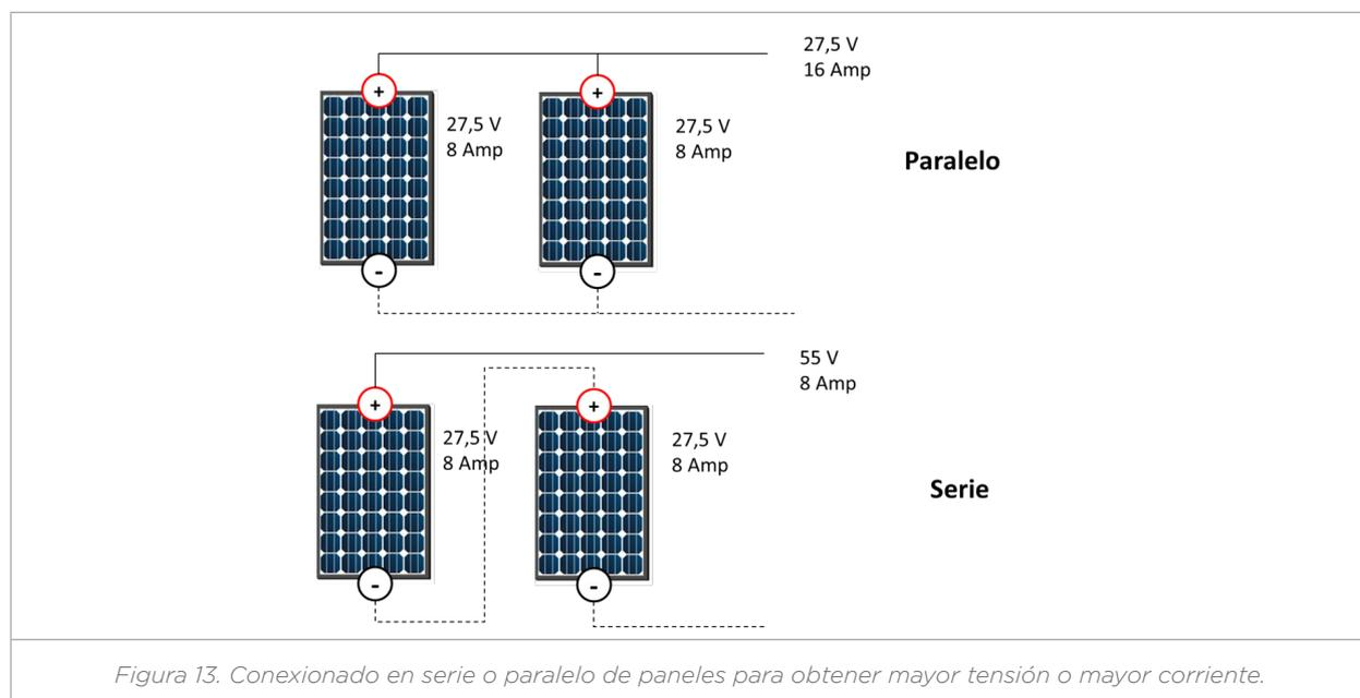
Figura 13. Conexionado en serie o paralelo de paneles para obtener mayor tensión o mayor corriente.
