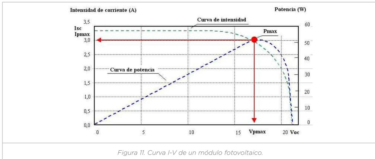
Figura 11. Curva I-V de un módulo fotovoltaico.
