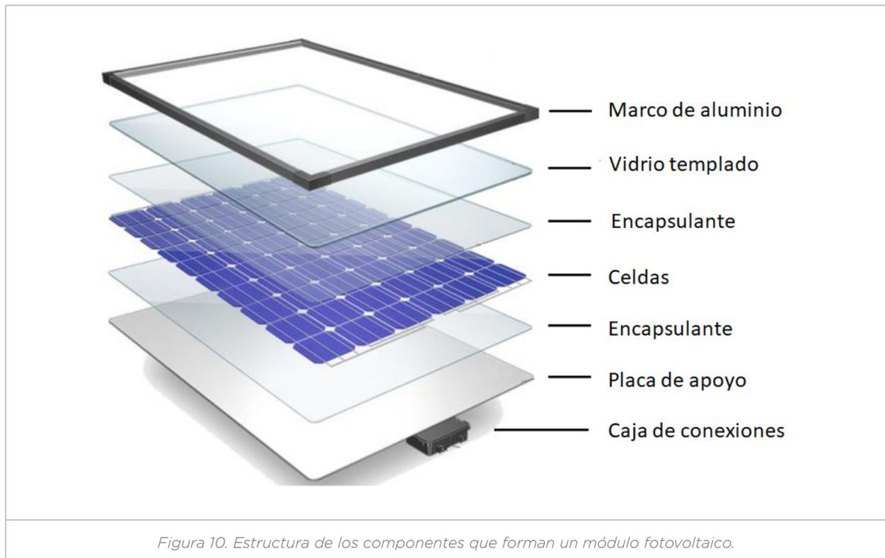
La potencia que entrega un módulo fotovoltaico depende esencialmente de la radiación solar disponible y la temperatura de las celdas del panel. De esta manera, a los fines de poder caracterizar el funcionamiento de un módulo fotovoltaico, se han definido condiciones de ensayo estándar o normalizadas denominadas, **STC** (del inglés, Standard Test Condition) que se enumeran a continuación:
