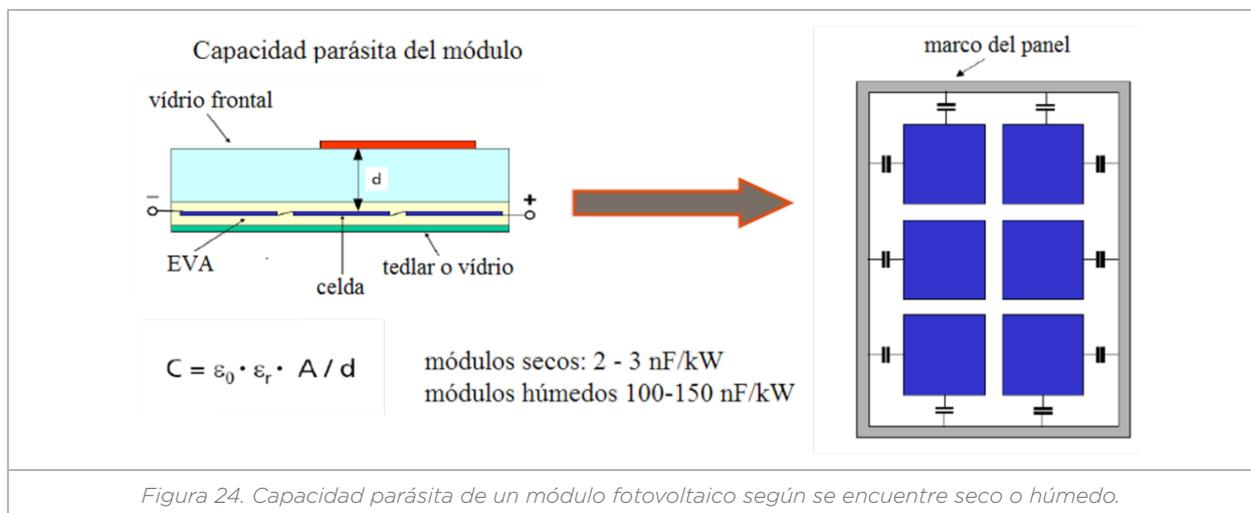
Figura 24. Capacidad parásita de un módulo fotovoltaico según se encuentre seco o húmedo.
