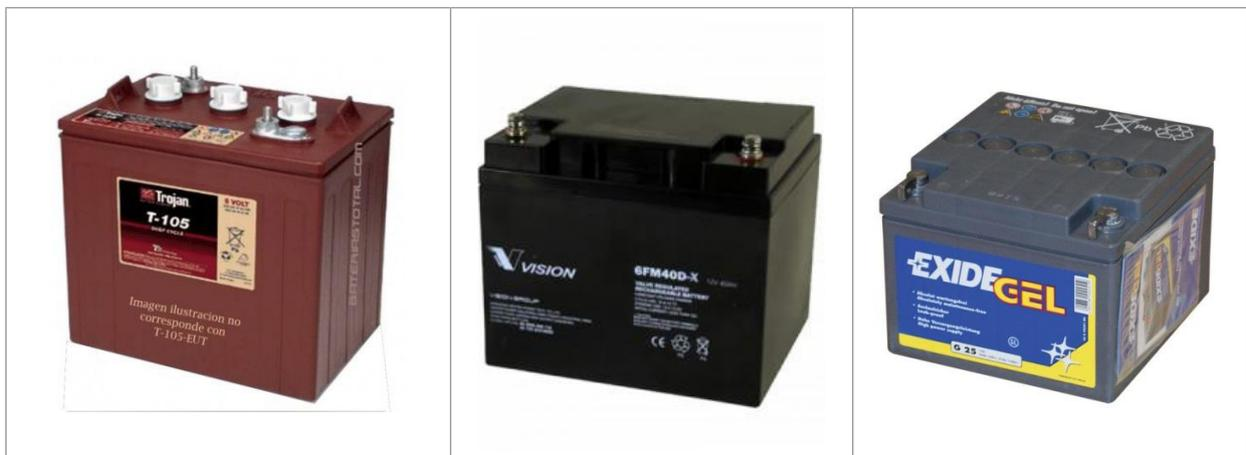
Figura 28. De izquierda a derecha, baterías de electrolito líquido, baterías de electrolito adsorbido y baterías de gel. Nótese que las de electrolito líquido poseen unas válvulas de acceso y las otras no.
