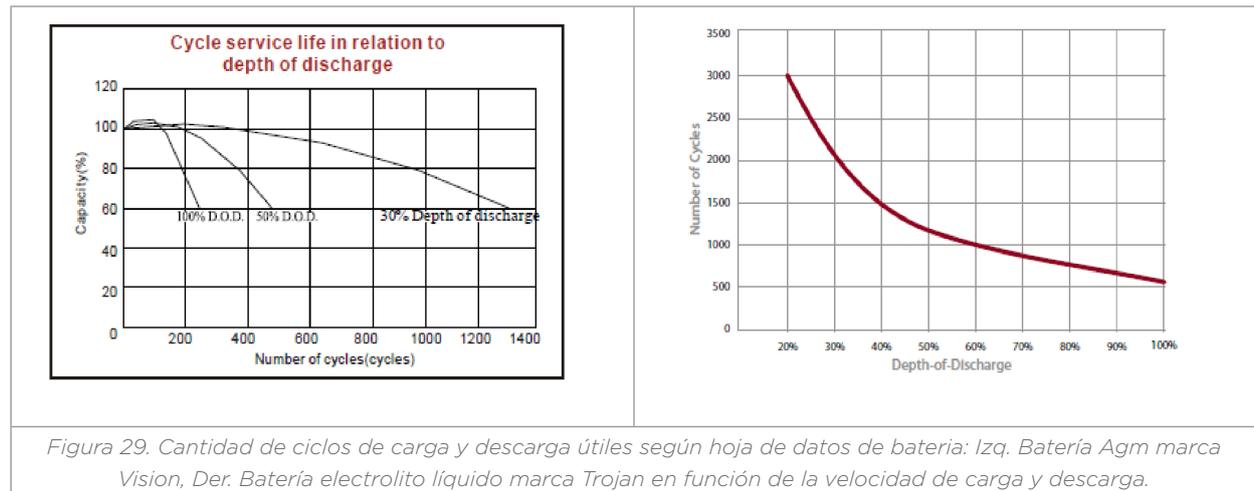
Figura 29. Cantidad de ciclos de carga y descarga útiles según hoja de datos de batería: Izq. Batería Agm marca Vision, Der. Batería electrolito líquido marca Trojan en función de la velocidad de carga y descarga.
