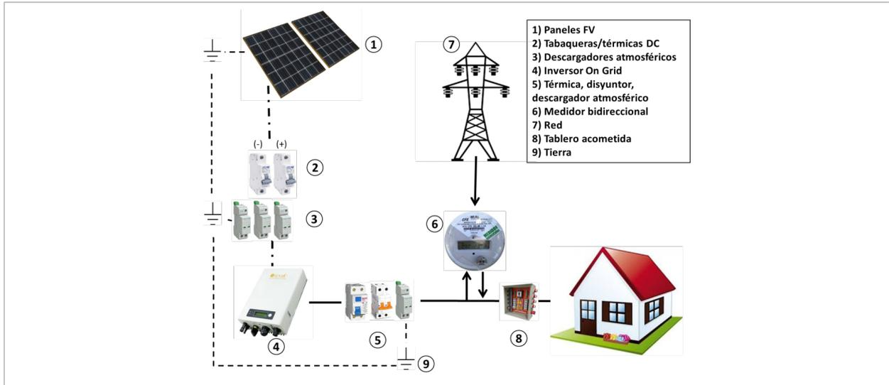
Figura 19. Esquema ilustrativo para el conexionado de paneles fv conectados a red.
