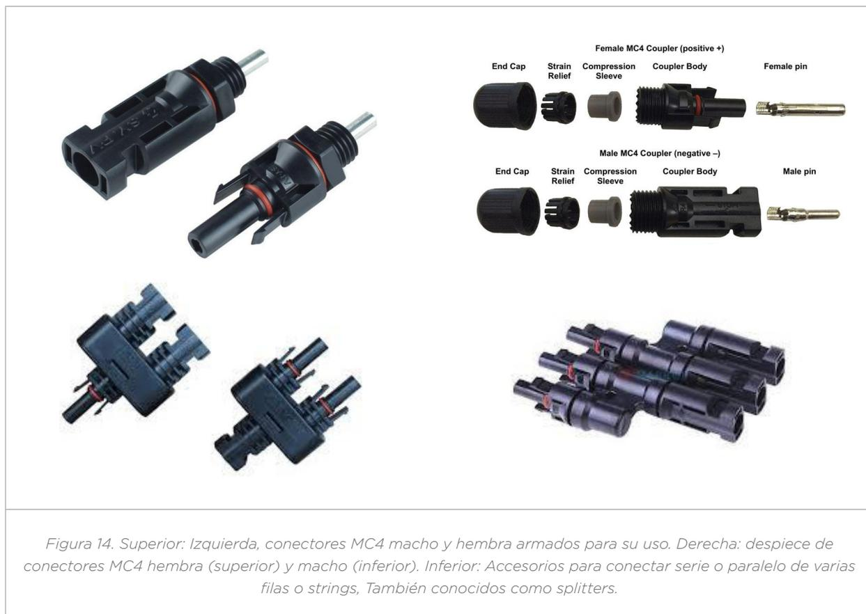
Figura 14. Superior: Izquierda, conectores MC4 macho y hembra armados para su uso. Derecha: despiece de conectores MC4 hembra (superior) y macho (inferior). Inferior: Accesorios para conectar serie o paralelo de varias filas o strings, También conocidos como splitters.
