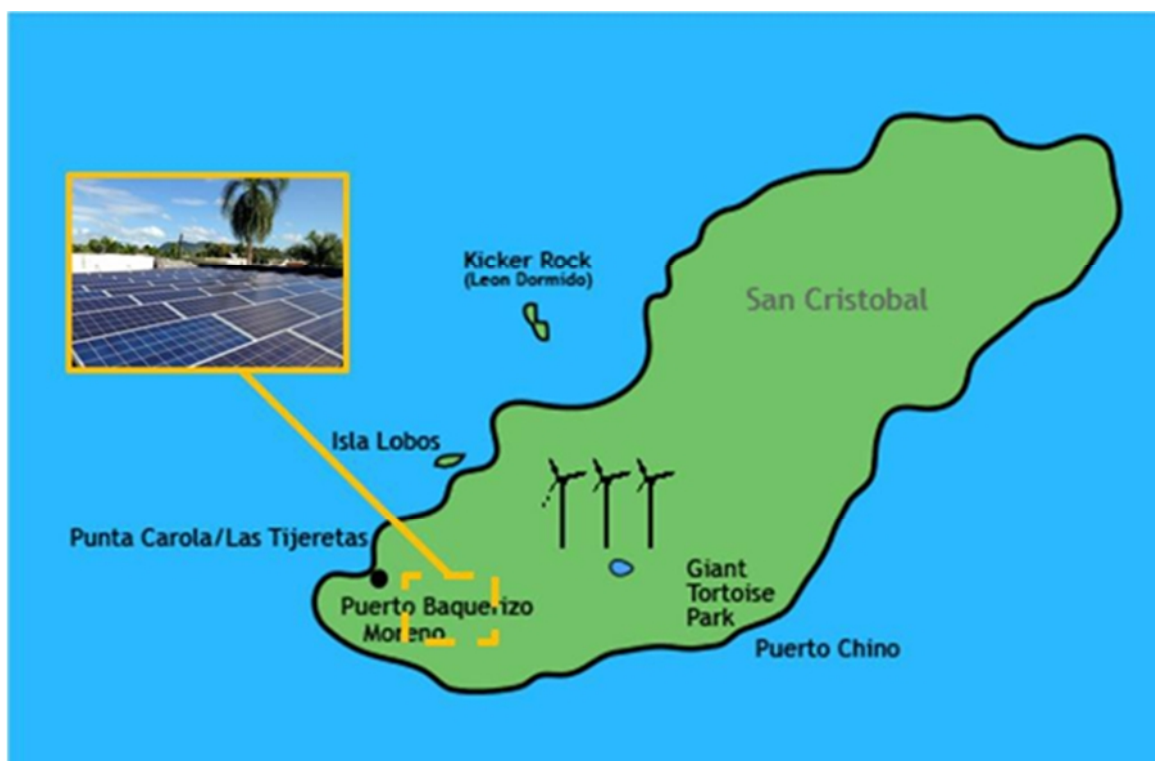
Figura 1: Red híbrida eólico-fotovoltaica en San Cristóbal (a 2016)
