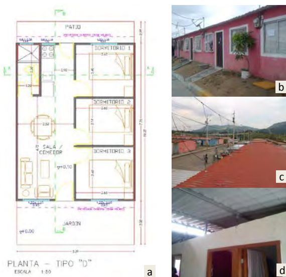
Figura 2: a) Diseño de vivienda del programa social b) Foto exterior frontal c) Foto interior de cubierta d) Foto exterior de cubierta.
