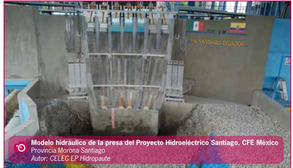
**Modelo hidráulico de la presa del Proyecto Hidroeléctrico Santiago, CFE México**
