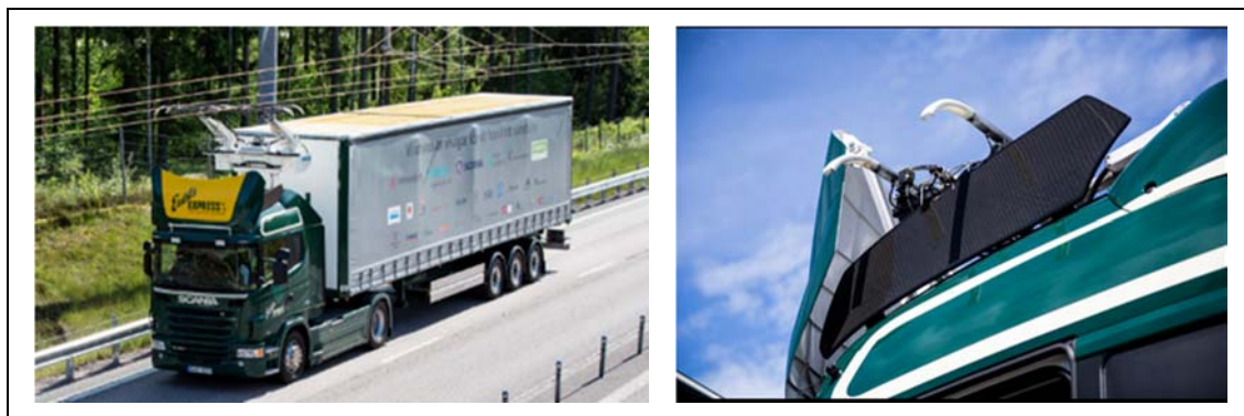
FIGURA 20. Camión híbrido de Scania en circulación (izquierda) y pantógrafo de recarga (derecha)
