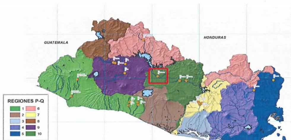
Figura: 16 MUESTRA REGIONES HIDROLÓGICAMENTE HOMOGÉNEAS PARA DETERMINACIÓN DE CAUDALES EN EL SALVADOR. MÉTODO ÁREA-PRECIPITACIÓN-CAUDAL.
