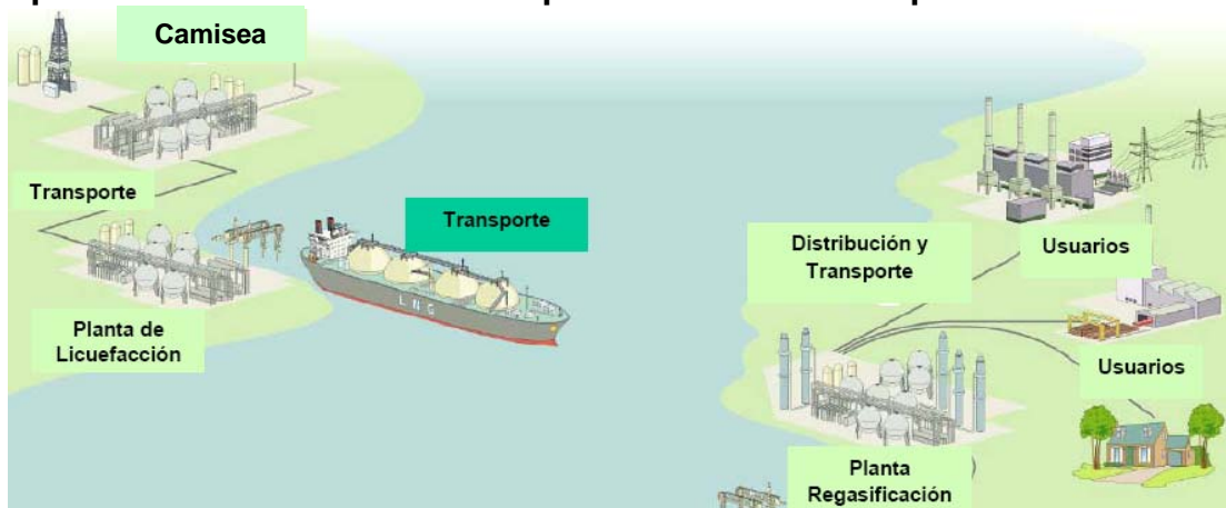
Gráfico N° 3.9 Esquema de las Actividades Comprendidas en el Transporte del GN vía LNG
