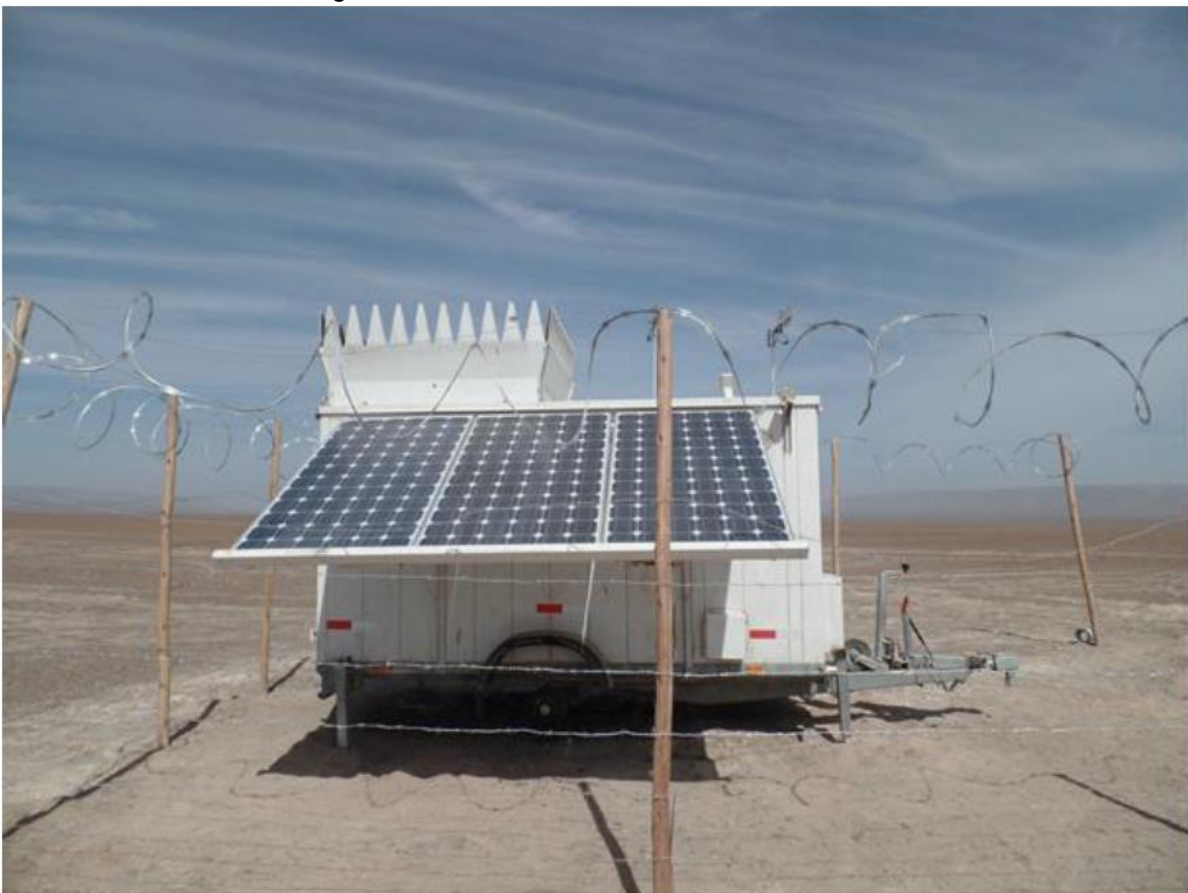
Figura 69. Sistema de medición remota SODAR.
