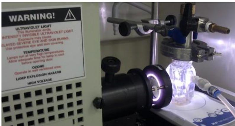
**Figura 8. Sistema para la producción de  $\text{H}_2$  mediante fotocatalisis.**
