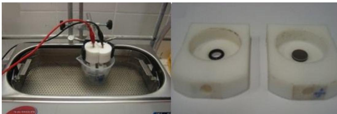
**Figura 4. Sistema de anodización.**
