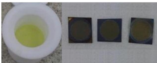
**Figura 7. Muestras típicas obtenidas. QDs de CdS coloidales y NTs de  $TiO_2$  sensibilizados con QDs de CdS.**
