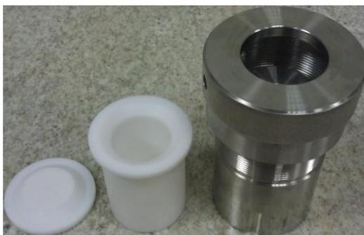
**Figura 6. Reactor de acero inoxidable con recipiente de teflón.**
