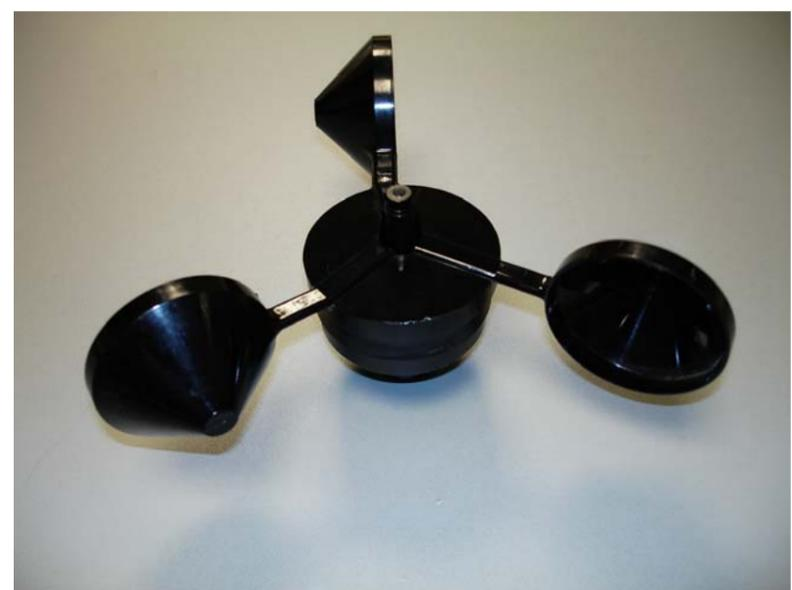
Figura 1. Anemómetro de cazoletas
