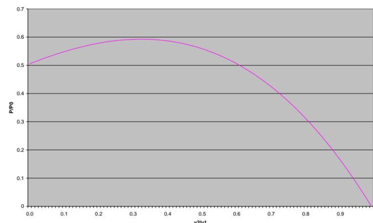
**Figura 4.** Energía extraíble del viento
