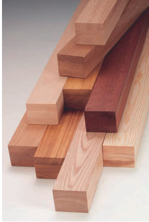
Foto 4.1. Perfiles laminados de madera.
