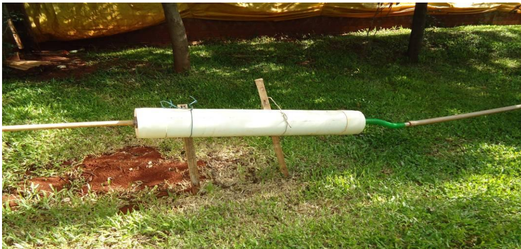
Figura 8 – Filtrado del biogás
