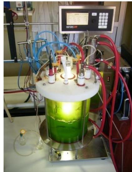
*Figura 2: FBR anular conectado al controlador Labforce para el cultivo de microalgas*
