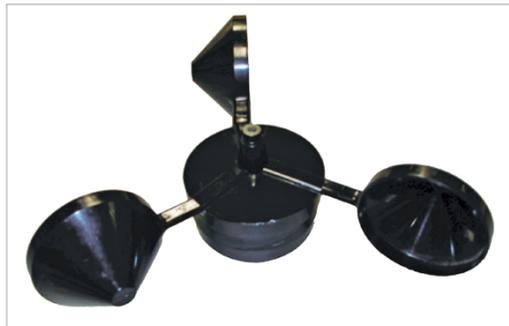
Figura 1. Anemómetro de cazoletas
