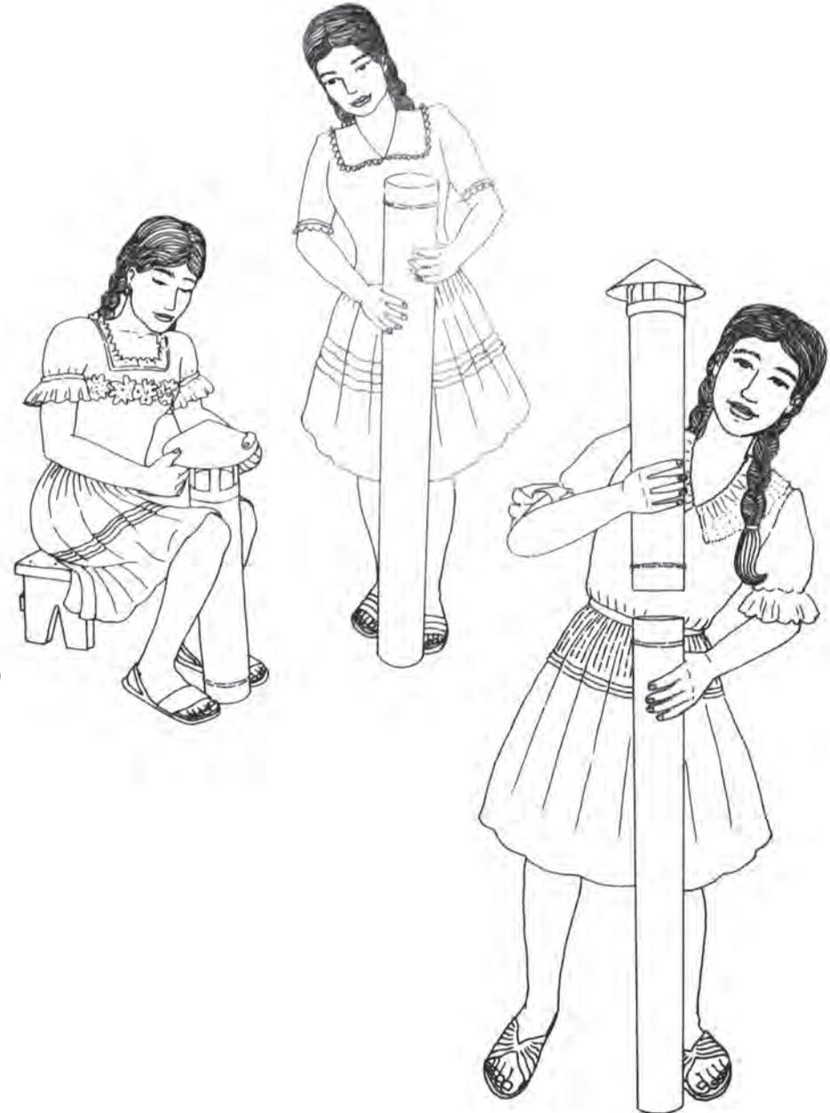
4. Para montar las chimeneas tenemos que hacer ganchos con alambre, para sujetarlas a la base de adobe, como podemos ver en la ilustración.
