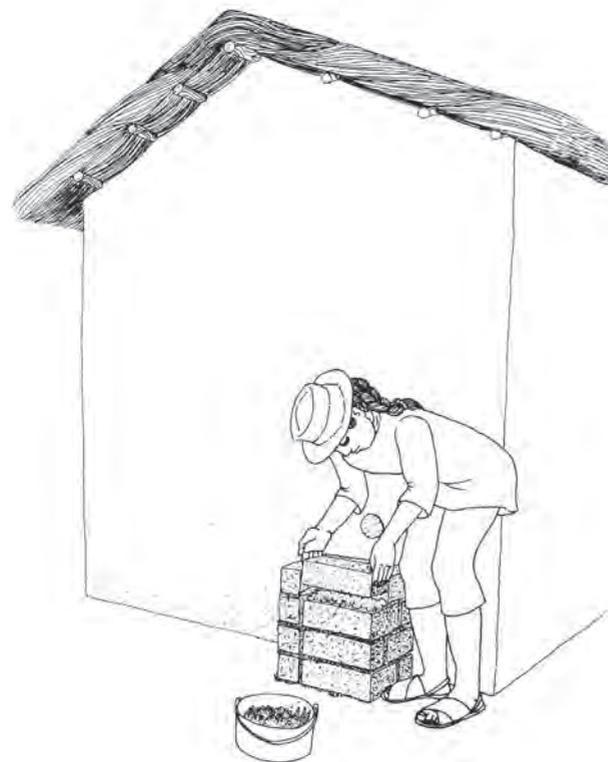
3. Cuando llegamos al nivel del hueco del muro, comenzamos a construir la chimenea de adobe, dejando un hueco en la primera hilada que servirá para la limpieza de la chimenea.
